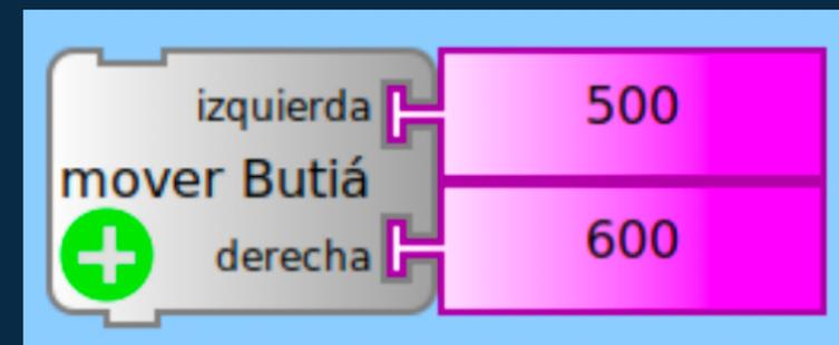
Bloque "mover Butiá": Mueve los dos motores del robot con las velocidades de los bloques (el bloque que dice "izquierda" será la velocidad del motor izquierdo, y el que dice "derecha" del motor de la derecha). Las velocidades pueden estar entre 0 y 1023.
