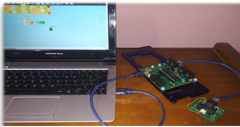
Imagen 5. La placa USB4Butiá conectada a la computadora
