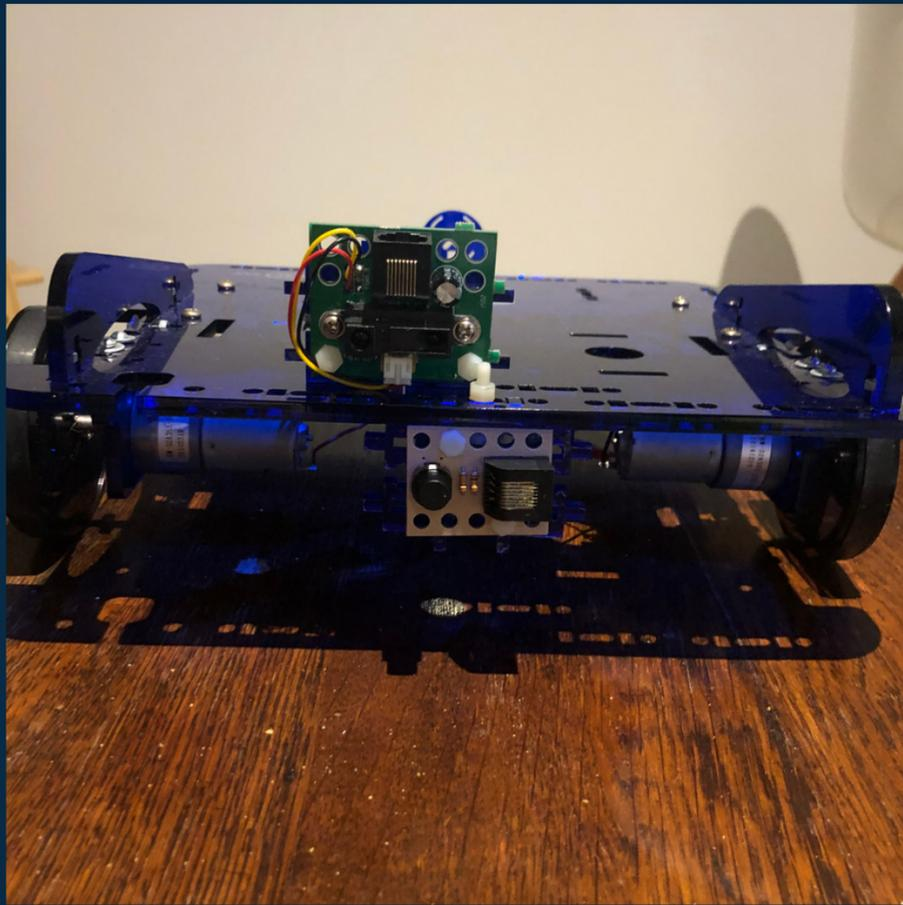
Usaremos el botón debajo del robot, bien al frente. Luego, usaremos el sensor de distancia arriba del robot, un poco más atrás, para no pegarle con la pelota
